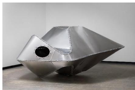
「月面構造物（飛び移り試験用実大モックアップ/滞在モジュール）」
