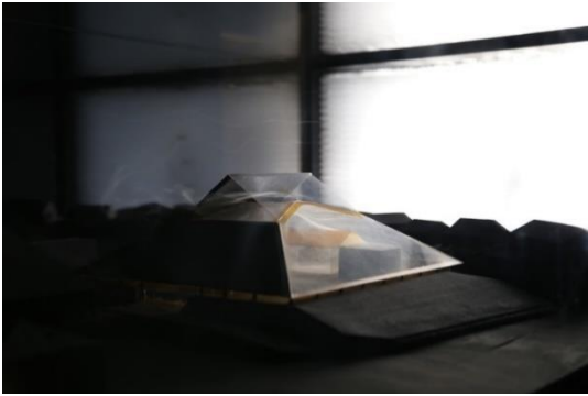
「直島ホール」風洞実験模型 ©三分一博志建築設計事務所
